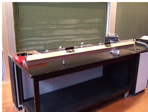
DEMO-17-2 Luftpudeskinne med 2 ryttere og 3 fjedre.
