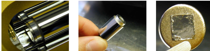
Figur 5.2: Til venstre kigger vi ind i skannerhovedet. Den runde metalcylinder er prøveholderen og til venstre under de to gyldne elektroder ses tippet. I midten og til højre ses prøveholder og prøve. Holderen bør kun berøres på plastikdelen. Prøven skal holdes med en pincet. Prøven er et 5 \times 5 \text{ mm} HOPG monteret på en metalplade.
